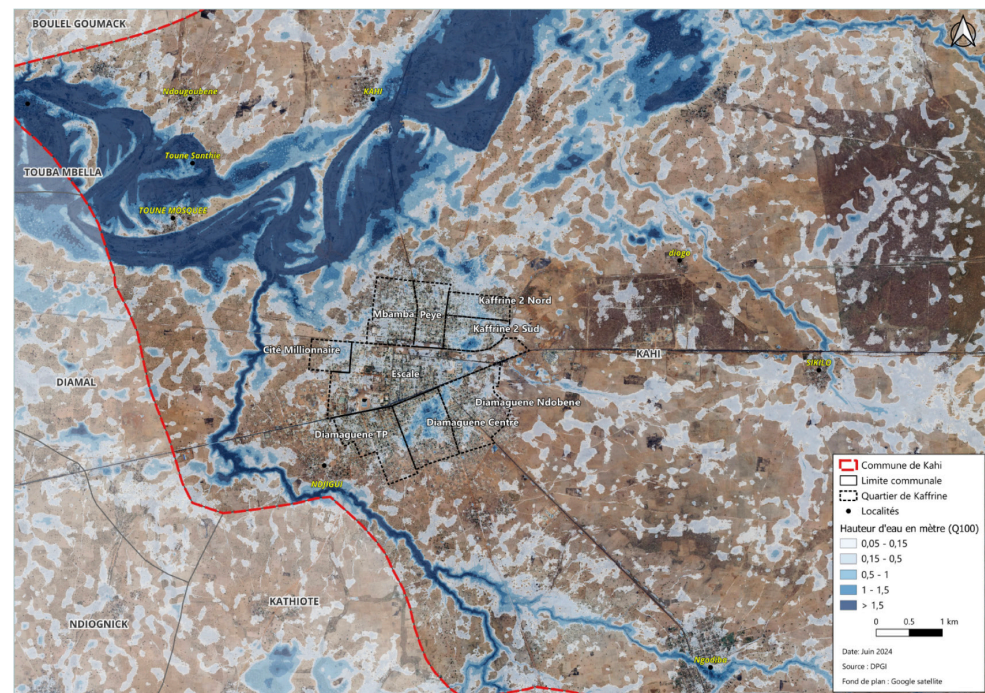
Figure 13 : Cartographie des hauteurs d'eau de la crue centennale sur Kaffrine (DGPI, 2023)
