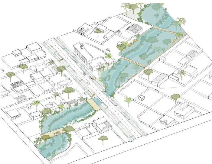
Schéma de principe du canal aval proposé sur Touba en cas de d'inondation importante et dont la conception est inspirée de la nature
